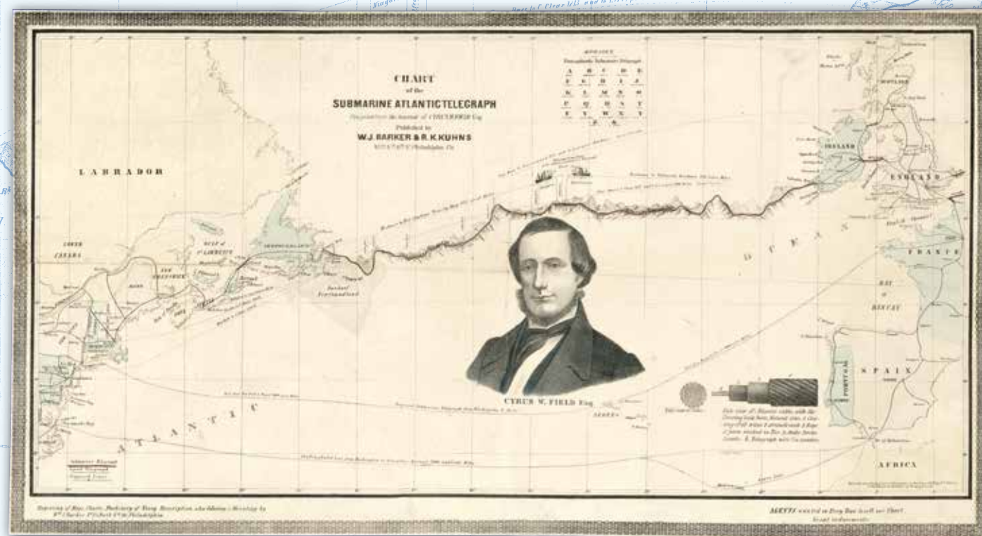
Diese Karte des Atlantiks aus dem Jahr 1858 zeigt den Verlauf des Telegraphie-Unterseekabels zwischen Nordamerika und Europa. Eine Besonderheit ist die Darstellung der Konturen des Unterseereliefs sowie der mit Echolot bestimmten Meerestiefen.
