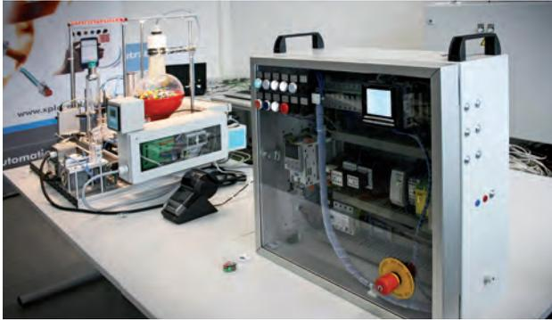
Der Demonstrator des New Automation e.V. zeigt anschaulich und sogar schmackhaft, welche Möglichkeiten modernste Industrie-4.0-Technologien bieten. Starten Sie den Fertigungsauftrag per Smartphone-App oder Sprachsteuerung. Anschließend wird eine Dose mit M&M befüllt und mit einem individualisierten QR-Code bedruckt.
